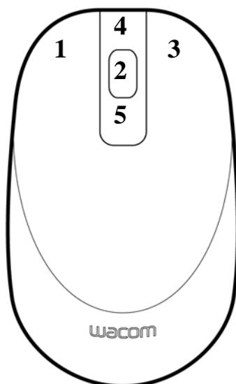
2. 「診断」ダイアログボックスを最初に開いた場合、「ホイール」の状態は0のはずです。ホイールを手前に回すと、「ホイール」の状態は0から+1に変われば正常です。
