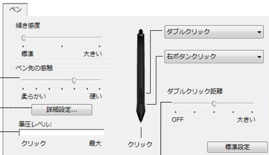
ペン先でタブレットの操作エリアを押して、設定した「ペン先の感触」をテストします。無理なく最大筆圧が得られるように、「ペン先の感触」をスライダで調整します。
