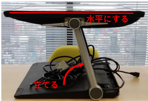
写真11 スタンド固定状態
